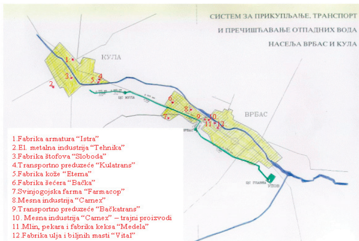
Систем за прикупљање, транспорт и пречишћавање отпадних вода Врбас и Кула (извор: Пројекат трајног решења пречишћавања отпадних вода на територији општина Врбас и Кула, презентација, 2000.)
